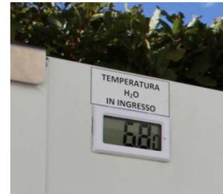
Il termometro digitale ti consente di misurare la temperatura dell'acqua per evitare lo stress degli animali allevati quando si aggiunge acqua in sostituzione di quella evaporata o assorbita dalle piante. Gli animali acquatici in generale infatti tendono a soffrire variazioni repentine della temperatura idrica.
